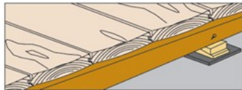
Figur 1. Vaskebræteffekt kan genopstå i trægulve som ikke er beskyttet mod fugtpåvirkning nedefra.
